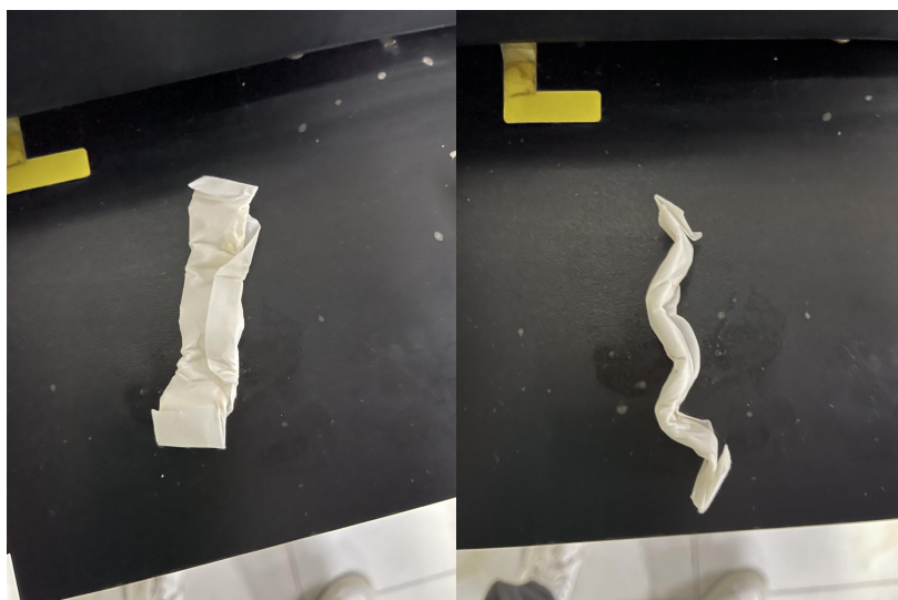
图三：将折叠好的包裹样品的滤纸塞入滤纸筒中，塞上脱脂棉，然后放到滤纸筒架里
