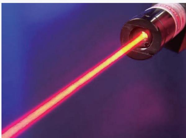
采用高波长精度, 高稳定性的氮氦激光器, 无惧温湿度变化的干扰, 为干涉仪提供精准参照。
