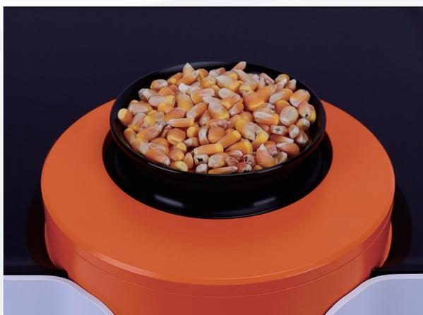
旋转样品台+大口样品杯的配置, 特别适合于大颗粒不均匀样品的扫描, 与仪器内部的镀金积分球一起, 保证得到高一致性的光谱数据。
